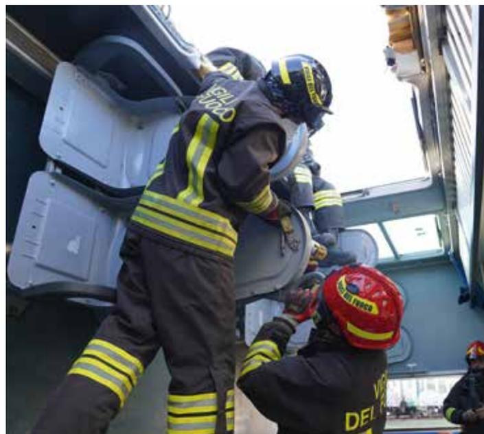
I tentativi di forzatura delle porte esterne hanno in entrambi i casi dato esito negativo o per la resistenza delle stesse o per la deformazione indotta che provoca l'incastro delle ante scorrevoli.
