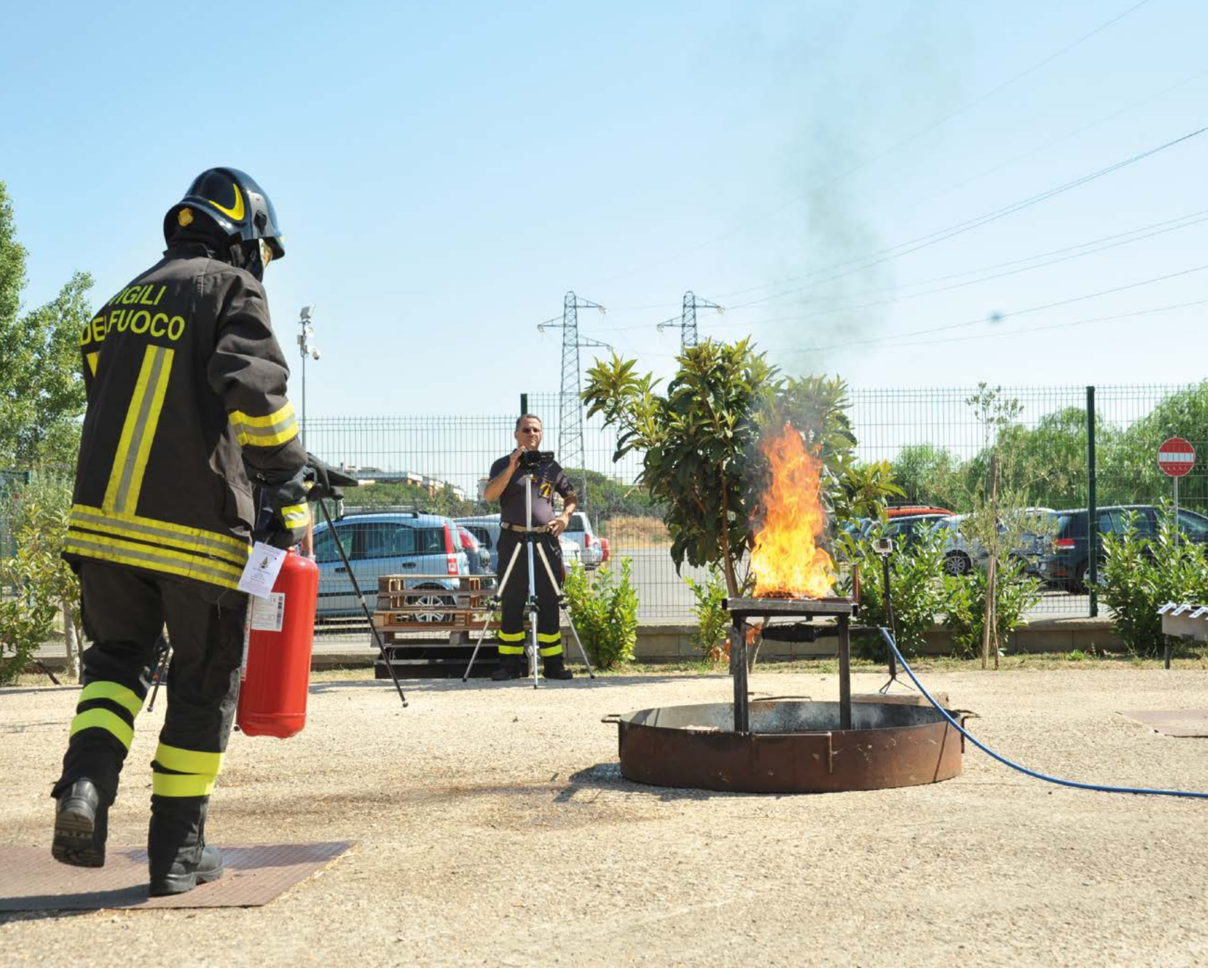
Test di spegnimento su batteria al litio
