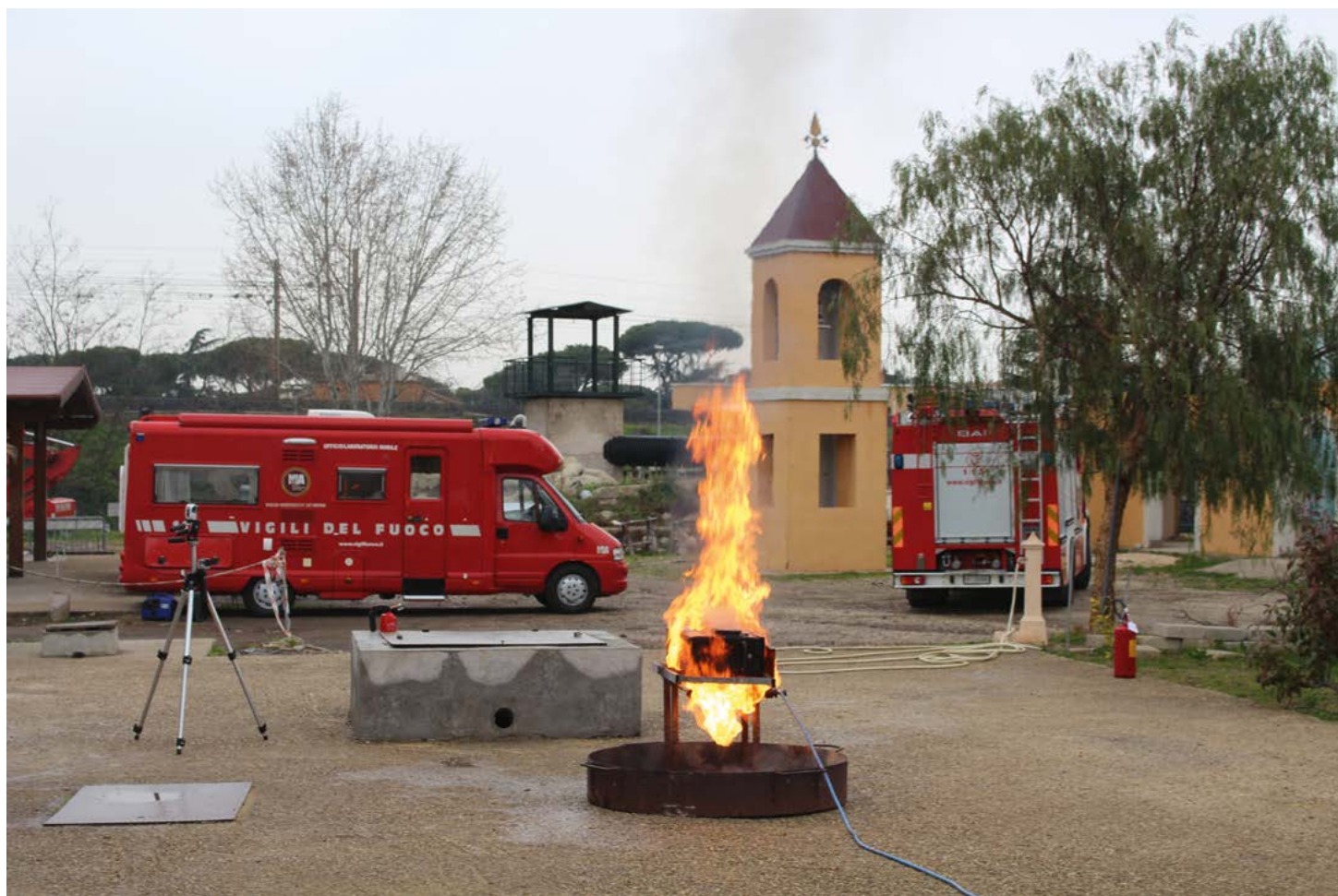
Test di infiammabilità su batterie al litio
