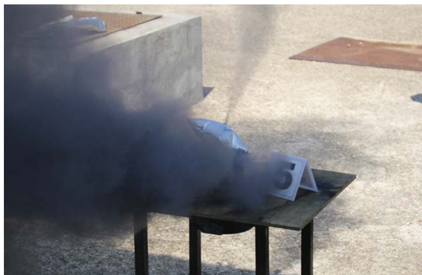
Abuso termico su batteria a ioni di litio con fenomeno di venting
