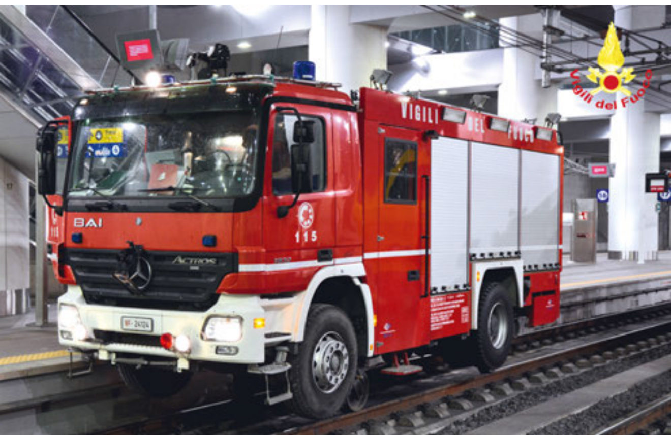
Nelle foto: l'ingresso dell'APS bimodale nella stazione.
