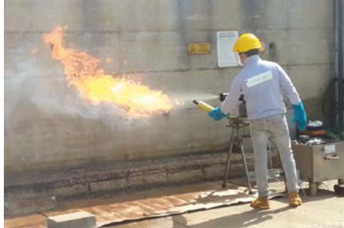
Figura 2: Sperimentazione sulla combustione degli esteri naturali
